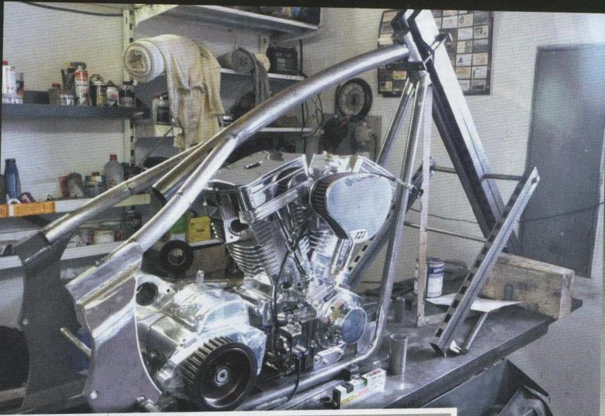
...a začala výroba rámu. Podle výkresů a návrhu začal Freeba vyrábět rámu. Nejprve řezání, broušení, ohýbání trubek, několik laserových výpalků a spasování všeho tak, aby se to mohlo sbodovat, ověřit správnost a souosost. Součástí byl samozřejmě motor a převodovka, aby vše bylo na takovém místě, kam to patří. A pak následovalo už samotné sváření rámu.
